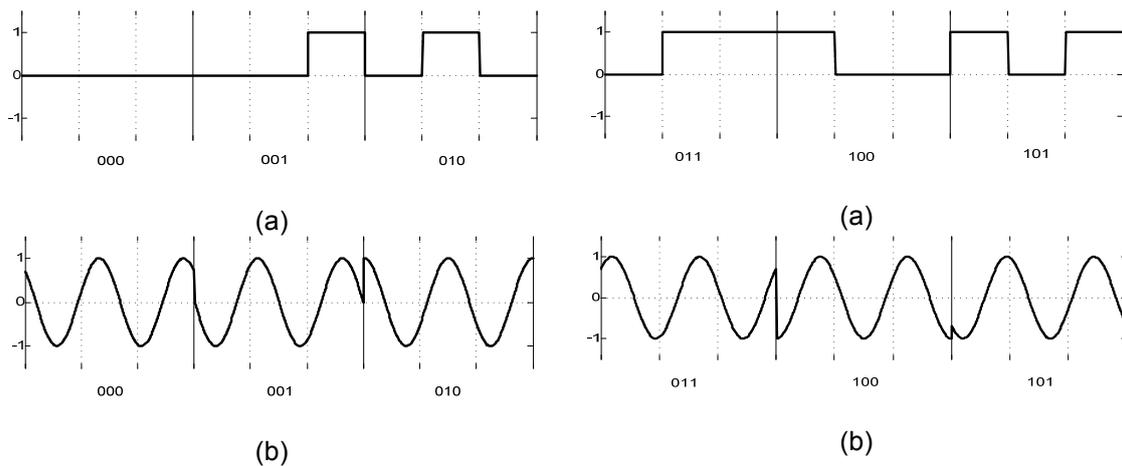
Gambar 4. Hasil simulasi (a) arus data biner (b) sinyal 8-PSK dengan arus data pada (a)
