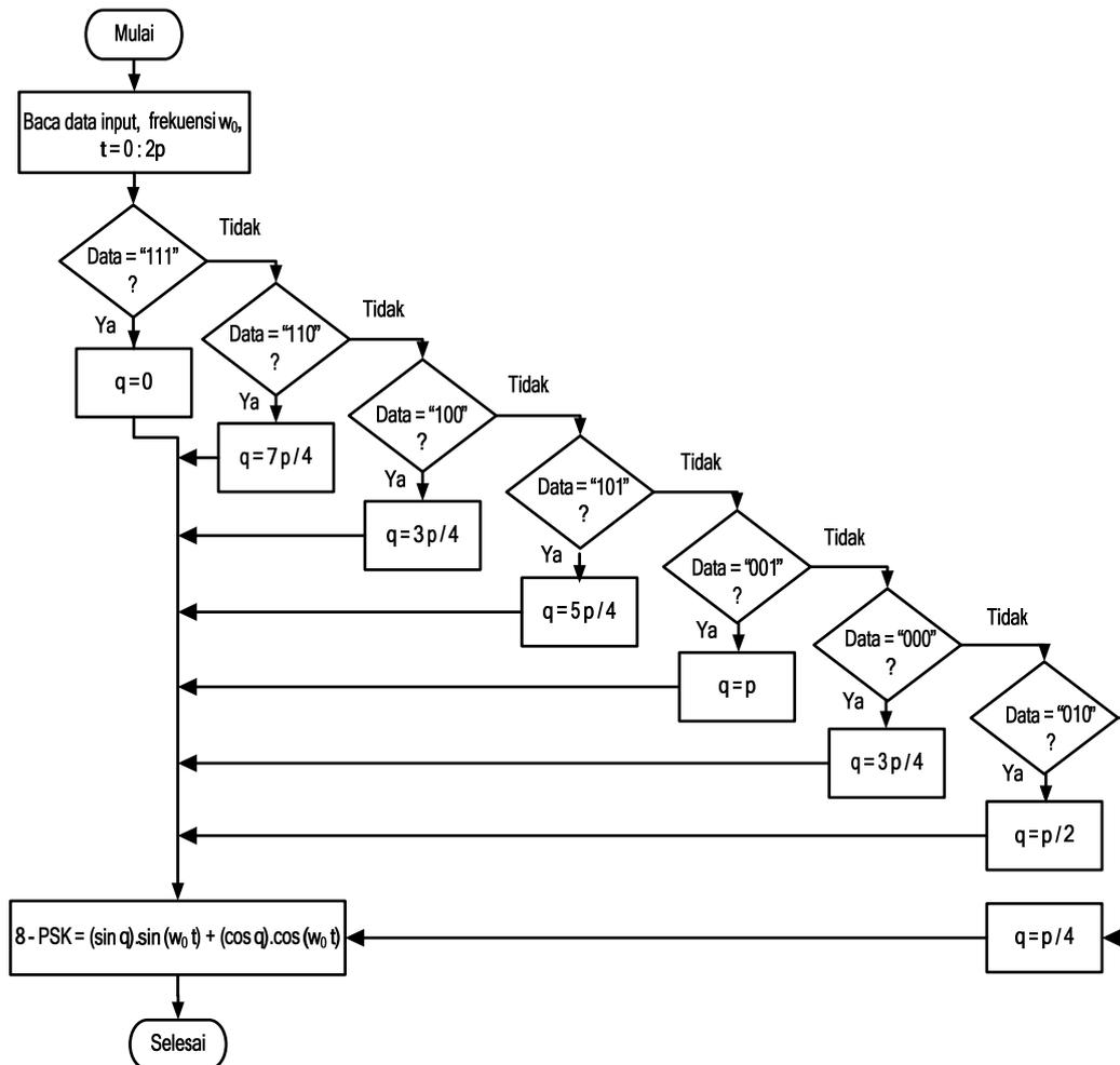
Gambar 3. Diagram alir simulasi pembangkitan sinyal 8-PSK
